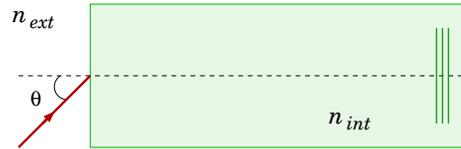
2.5) Un rayo de luz incide desde el aire en un bloque de vidrio que está casi completamente sumergido en alcohol como se indica en la figura. Los índices de refracción están dados por  $n_{vidrio} = 1,52$ ,  $n_{alcohol} = 1,36$ , y  $n_{aire} = 1$ . Hallar  $\alpha$  para que el ángulo de incidencia en P sea el ángulo crítico (vidrio-alcohol).
