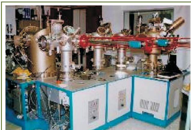
Figura 4. Equipo de Epitaxia por Haces Moleculares (MBE)
